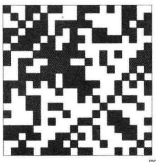
图 9-10 对  $H$  矩阵进行 Schur 消元后的  $S$  矩阵的稀疏状态
