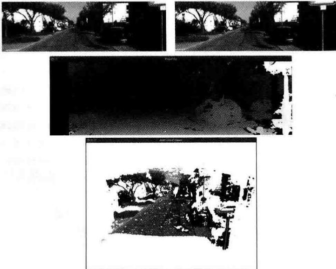
图 5-9 双目视觉的例子，左上：左眼图像，右上：右眼图像，中间：SGBM 的视差图，下方：点云图。注意，因为左侧相机看到了一部分右侧相机没有看到的内容，所以对应的视差是空的
